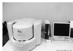
写真3. 蛍光X線分析装置 (EDX-800HS)
