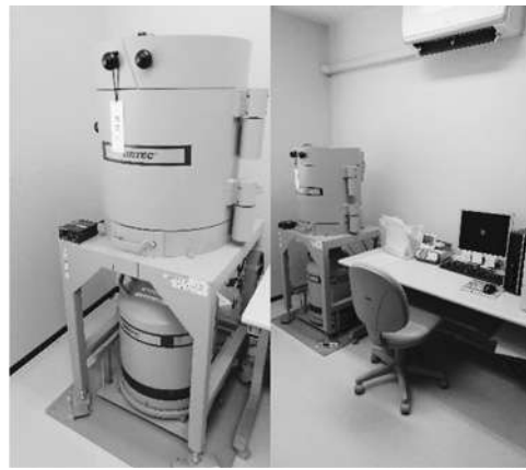
写真1. Ge半導体検出器とRI測定室
