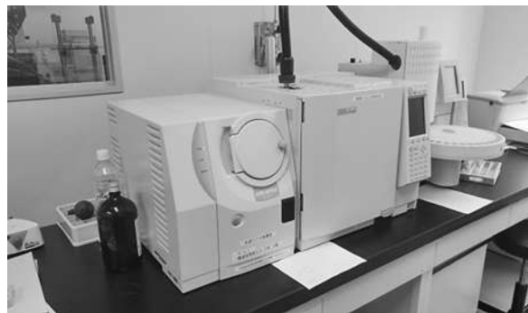
写真3. トリハロメタン検査に用いる ヘッドスペース型 GC-MS
