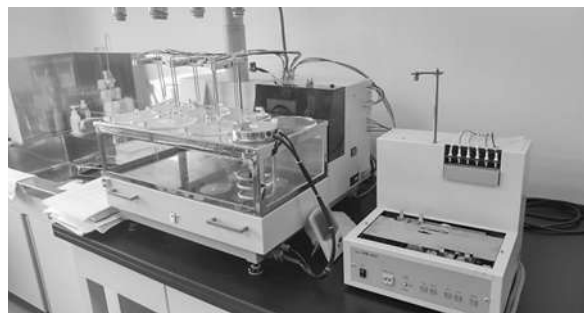
写真1. 計画的試験に用いる溶出試験器
