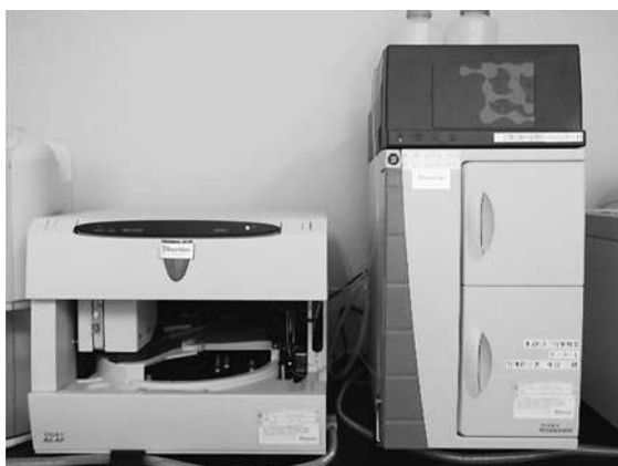
陽イオン類を測定するイオンクロマトグラフ
