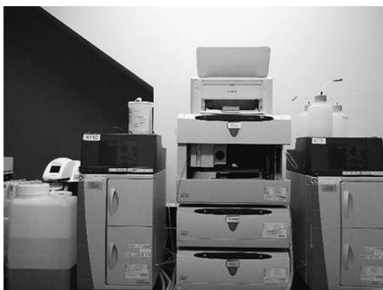
陰イオン類を測定するイオンクロマトグラフ
