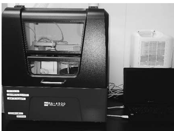
水銀を測定する還元気化全自動測定装置
