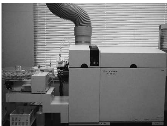
金属類の一斉分析を行う誘導プラズマ質量分析装置
